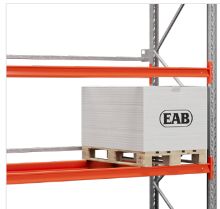
Horizontale palletstop - te monteren aan de achterkant van het frame om te voorkomen dat pallets te ver worden doorgeschoven.
